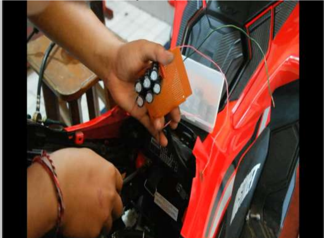
Pemasangan Voltage Stabilizer
