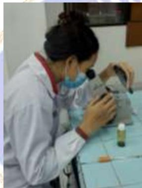
Proses pengamatan sampel menggunakan refraktometer Abbe
