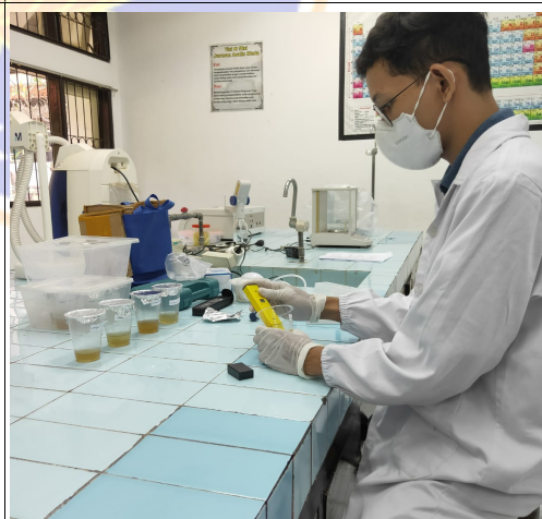
Analisis konsentrasi pH menggunakan pH meter
