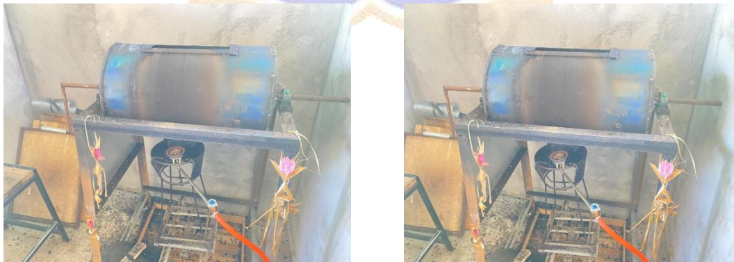
Gambar 03. Mesin Guling untuk menyangrai kopi
