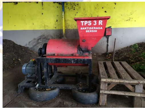
Gambar 18. Foto mesin pencacah sampah di TPS 3R Desa Baktiseraga Sumber: dok. Juliandi, 2022
