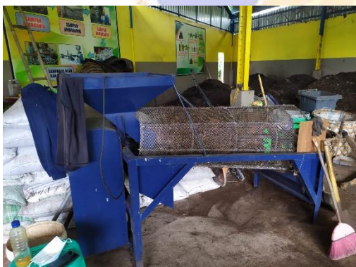
Gambar 17. Foto mesin pengayak sampah di TPS 3R Desa Baktiseraga Sumber: dok. Juliandi, 2022
