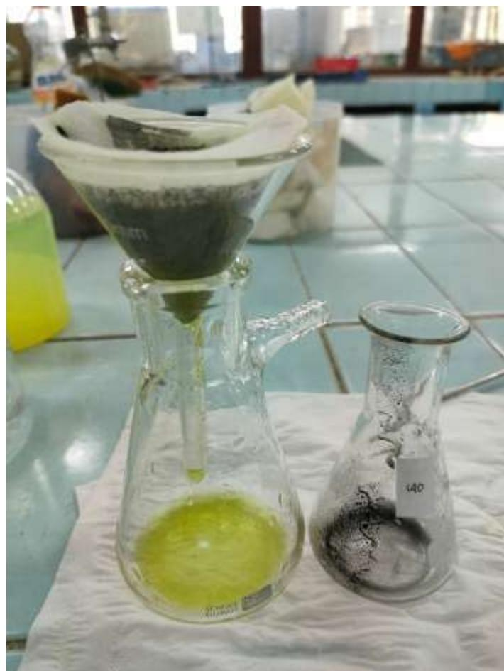
Proses penyaringan setelah melakukan kontak antara zat warna dan karbon aktif
