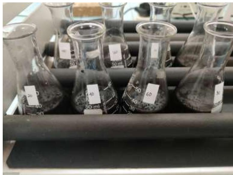
Proses kontak arang dengan zat warna menggunakan shaker
