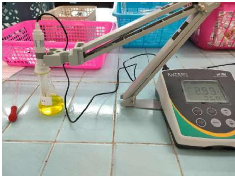
Pengkondisian pH dengan menggunakan pH meter untuk melakukan variasi uji pH
