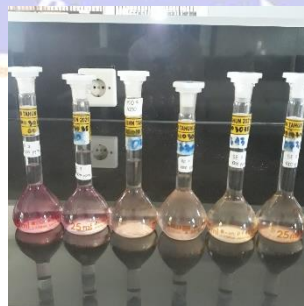
Larutan induk uji aktivitas antioksidan ekstrak kelopak bunga rosella segar, kering oven, dan kering freeze dried
