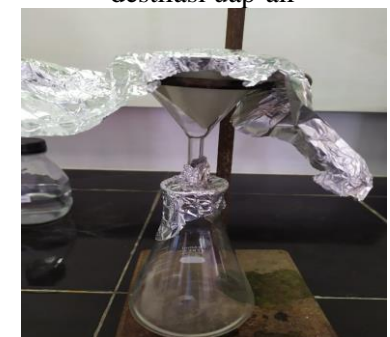
Proses penyaringan filtrat setelah ditambahkan natrium sulfat anhidrat
