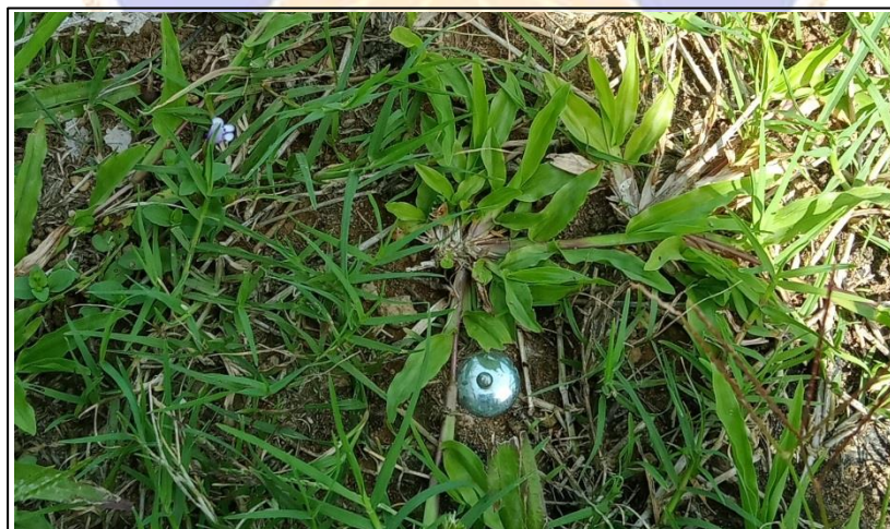
Lampiran 2 : pembuatan titik BM ( Bench Mark) menggunakan paku payung
