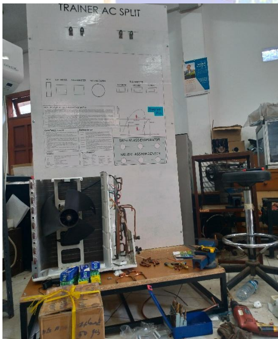
Gambar 3. Tahap pemasangan unit outdoor dan indoor
