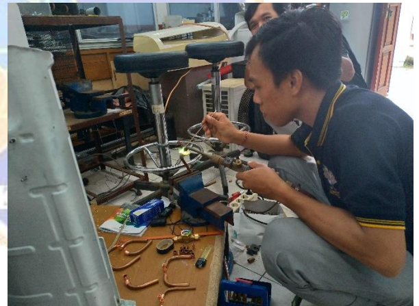
Gambar 4. Tahap pengelasan nepel Sight Glass
