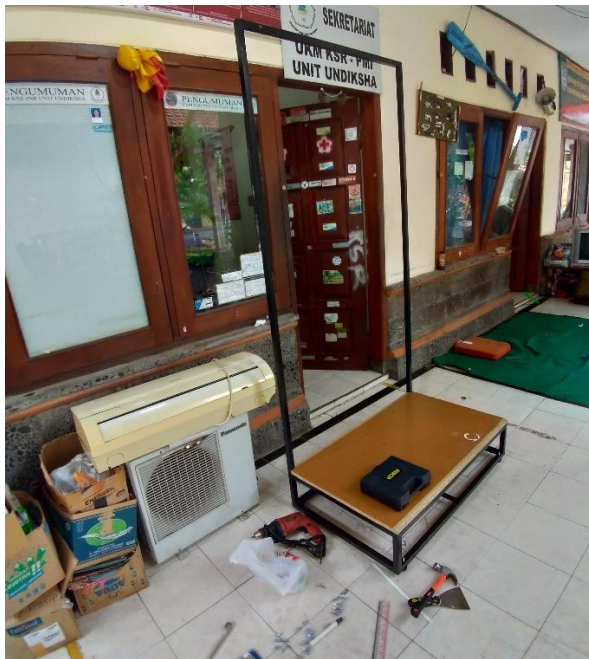
Gambar 1. Tahap pembuatan rangka dan pemasangan papan
