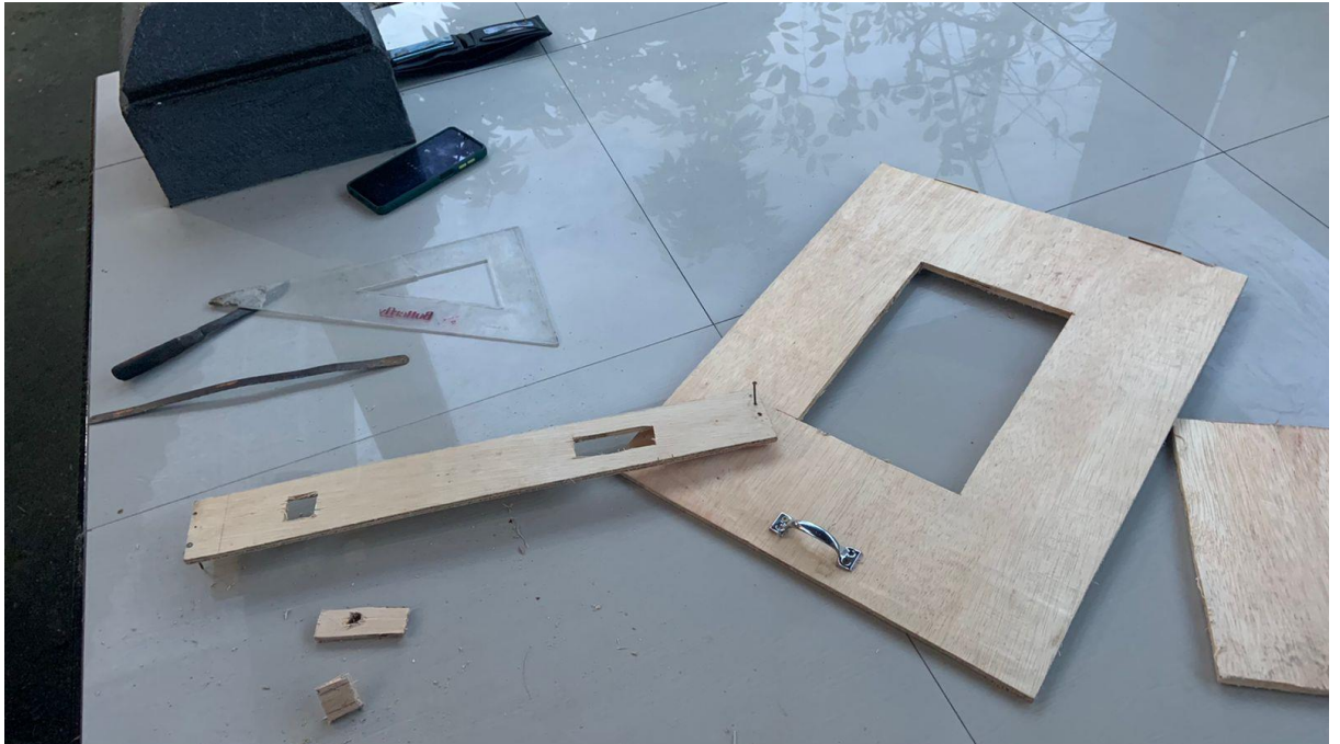
Gambar 5.1 pembuatan pintu mesin penetas telur
