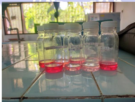
Sampel zat warna setelah adsorpsi dan siap diukur konsentrasinya dengan spektro UV-Vis
