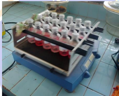
Proses homogenasi adsorben dan zat warna menggunakan shaker
