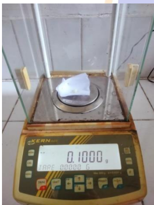
Proses menimbang adsorben (0,1 g)
