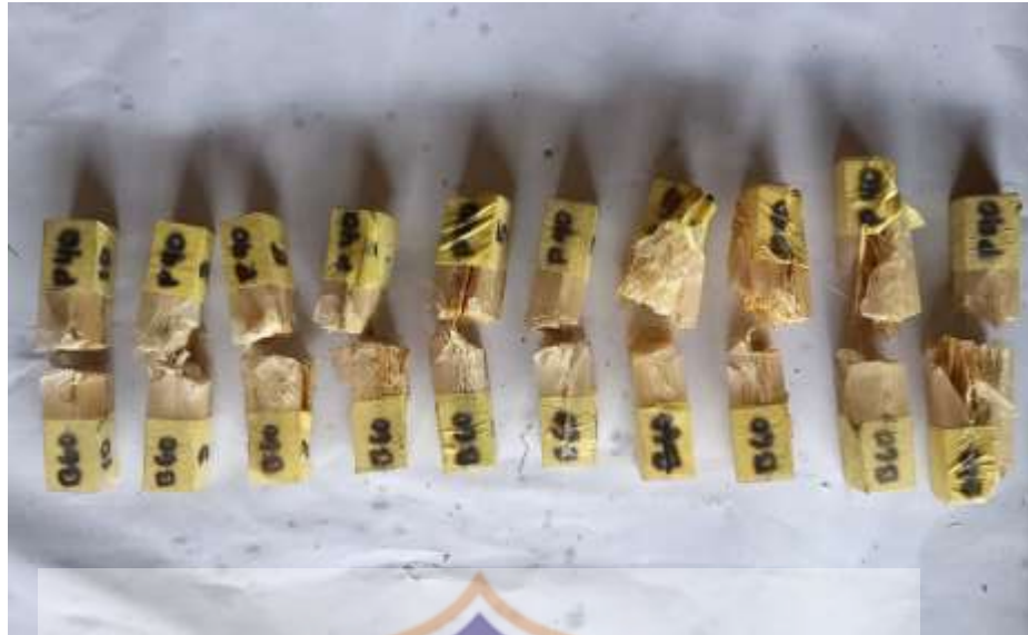
Bentuk patahan setelah uji impact
