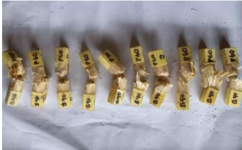
Bentuk patahan setelah uji impact
