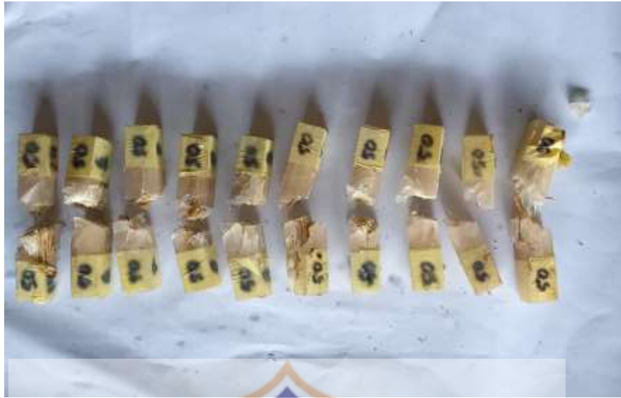
Bentuk patahan setelah uji impact
