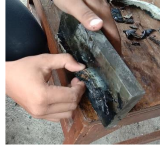
Gambar 47 Proses Pelepasan Handle Rem dari Cetakan
