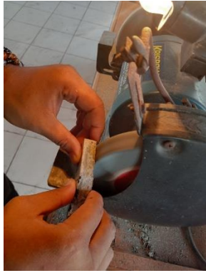
Gambar 57 Proses Meratakan Permukaan Handle Rem
