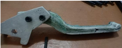
Gambar 60 Pemasangan Handle Rem Dengan Anting Handle
