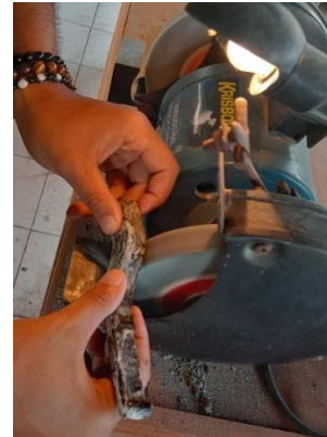
Gambar 48 Proses Meratakan Permukaan Handle Rem
