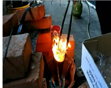
Gambar 26 Proses Peleburan Bahan PET dan LDPE
