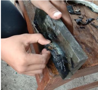
Gambar 37 Proses Pelepasan Handle Rem Dari Cetakan
