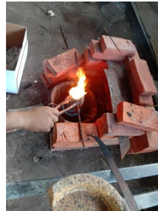
Gambar 55 Proses Peleburan Bahan PP dan HDPE
