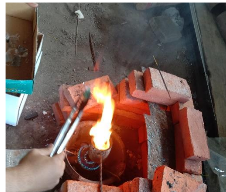
Gambar 35 Proses Peleburan PET dan PP
