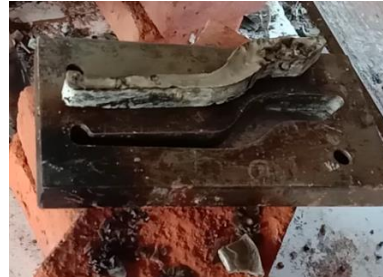
Gambar 28 Proses Melepaskan Handle Dari Cetakan
