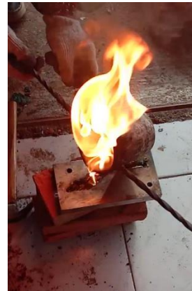
Gambar 27 Proses Penuangan Bahan PET dan LDPE
