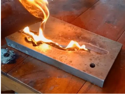
Gambar 36 Proses Penuangan Bahan PET dan PP
