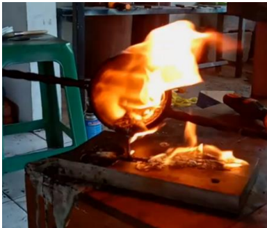
Gambar 45 Proses Peleburan Bahan PET dan PS
