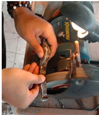
Gambar 38 Proses Meratakan Permukaan Handle Rem
