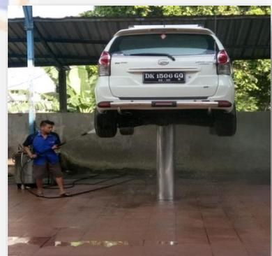
Gambar 4: Pompa Hidrolis Pengangkat Mobil
