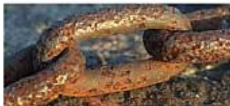
Gambar 7. Perkaratan pada besi Sumber: Liputan6.com
