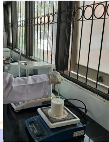
Gambar 02. Proses pasteurisasi susu Sumber: dokumentasi pribadi
