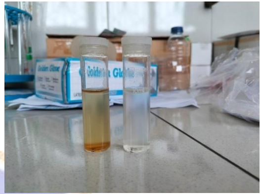
Sampel uji dan blanko untuk pengujian aktivitas enzim amilase
