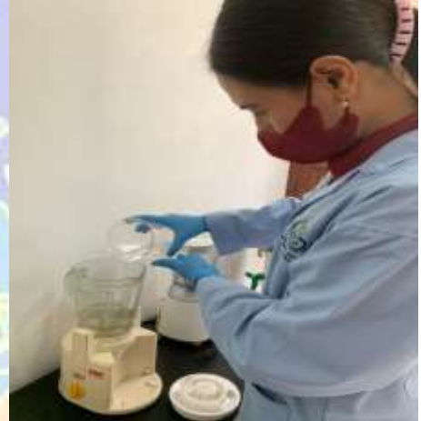
Gambar 4. Proses homogenisasi sampel pengujian TSS
