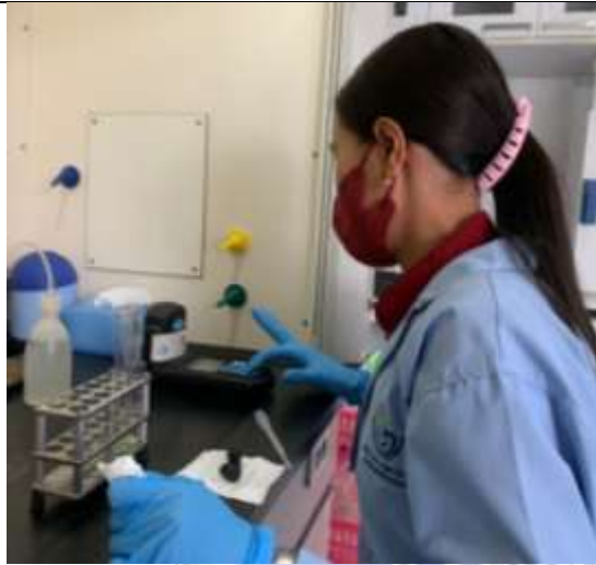
Gambar 7. Proses pengujian fosfat dengan spektrofotometer HACH
