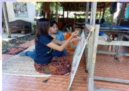
Gambar : Proses pengikatan motif menggunakan tali raphiah sesuai warna motifnya
