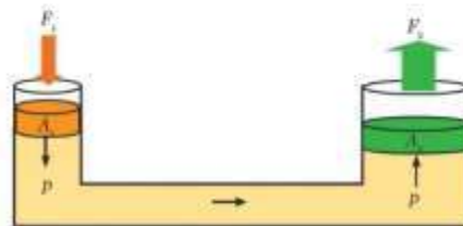
Gambar 1.8 Diagram Pompa Hidrolik
