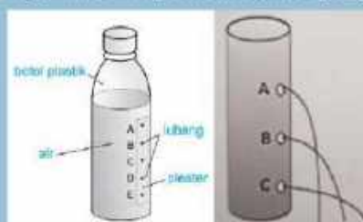
Gambar 12. Model Percobaan Tekanan Hidrostatik pada Botol
