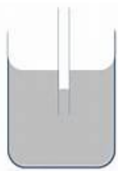
Meniskus cembung Kohesi > Adhesi \theta > 90^\circ (Sudut lancip)
