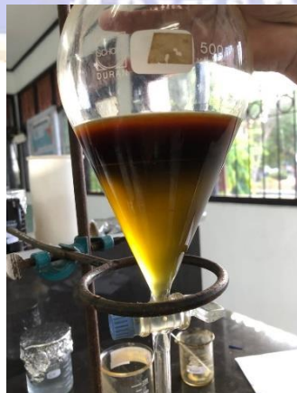
Partisi menggunakan pelarut diklorometana
