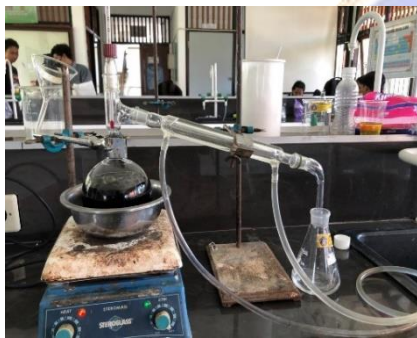
Pemekatan ekstrak menggunakan destilasi sederhana.
