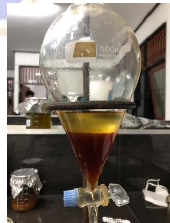
Partisi menggunakan pelarut etil asetat
