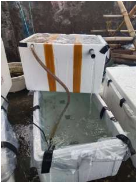
Gambar 3. Filter R2 (Batu Apung, Arang, dan Pasir)
