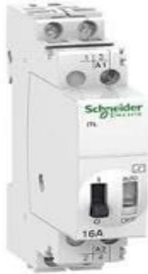
Saklar impuls adalah saklar yang bekerja dengan menggunakan prinsip elektro magnetis. Saklar ini mempunyai dua bagian komponen penting dimana kerja salah satu komponen dipengaruhi komponen lainnya. Bagian pertama dari komponen tersebut adalah coil dengan spesifikasi tegangan tertentu, dan bagian beeerikutnya adalah kontak dengan spesifikasi arus tertentu.
