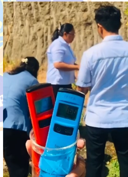
Gambar 4. Pengukuran pH dan TDS
