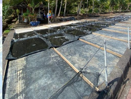
Gambar 4. Kolam pemekatan air garam setelah penyaringan dengan tinjung
