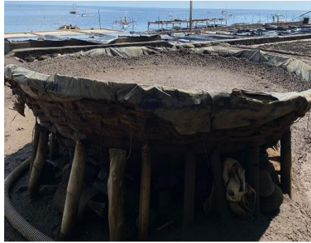
Gambar 2. Alat penyaringan air laut (tinjung) yang terbuat dari anyaman bambu
