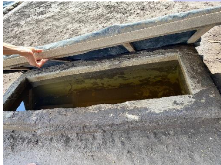
Gambar 3. Wadah penampungan air garam hasil penyaringan dengan "tinjung"
