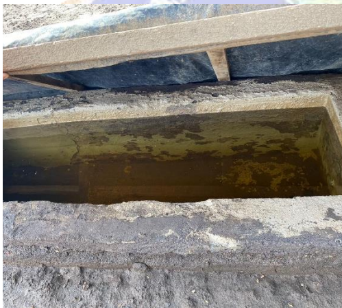
Gambar 3. Wadah penampungan air garam hasil penyaringan dengan tinjung
