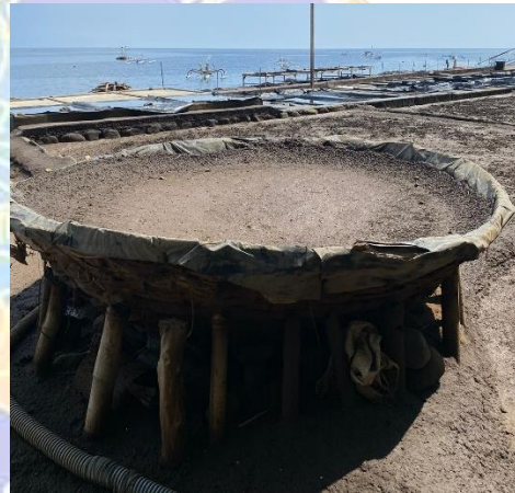
Gambar 4. Alat penyaringan air laut (Tinjung) yang terbuat dari batang bambu dan berbentuk corong
