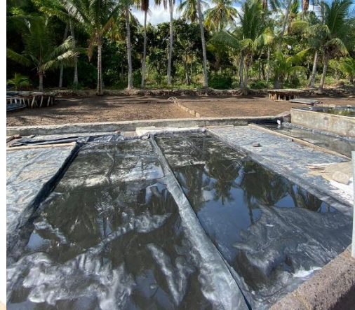
Gambar 2. Kolam pemekatan air garam setelah penyaringan dengan tinjung
