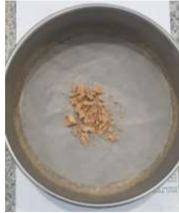
Penyakan abu batubara
