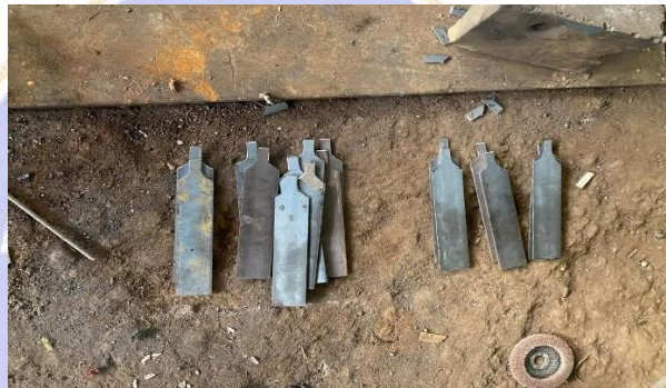
Gambar 5.1 baja karbon ST42, yang sudah di bentuk sesuai ASTM E8 (sumber : dokumen pribadi 2024)
