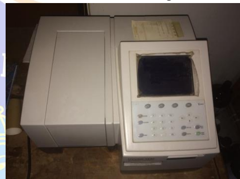
Pengukuran Absorbansi RBB Dengan Spektrofotometer UV-Vis
