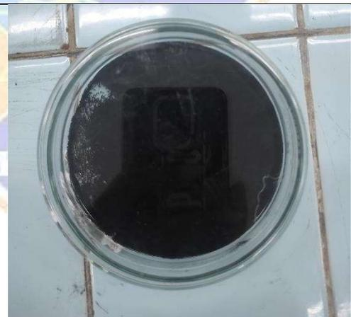
Proses karbonisasi  $\text{TiO}_2$  dengan karbon menggunakan furnace dan gas argon (Ar), pada suhu  $450^\circ\text{C}$  dalam waktu 2 jam.
