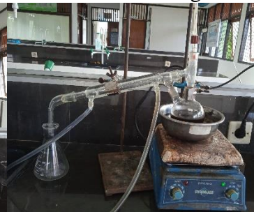
Gambar 6. Penguapan pelarut dengan Destilasi
