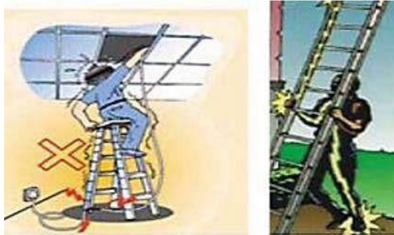
Gambar 4.16. Penggunaan Tangga Di Daerah Instalasi Listrik
