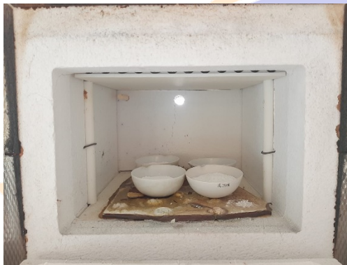
Serbuk batu kapur yang akan dikalsinasi menggunakan furnace
