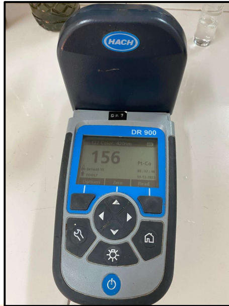
Tahap Pengecekan Kadar Warna Dan Kadar Total Suspended Solid Pada Limbah Industri Hasil Aerasi Menggunakan Alat Hach Dr 900
