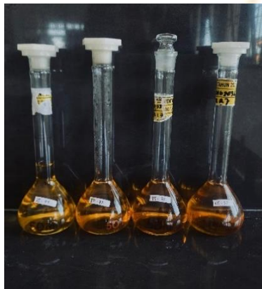
Pembuatan larutan kurva standar
