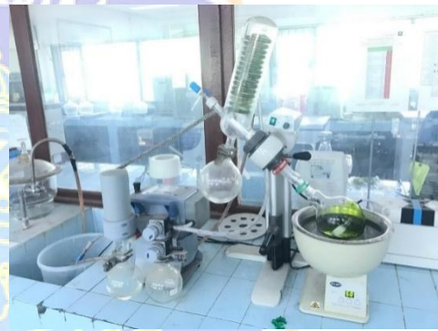
Lampiran 4h Proses evaporasi dengan rotary evaporator .
