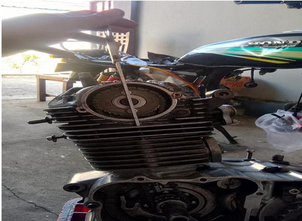
Pengukuran Terhadap Kompresi Untuk Menentukan Bahan Bakar Yang digunakan
