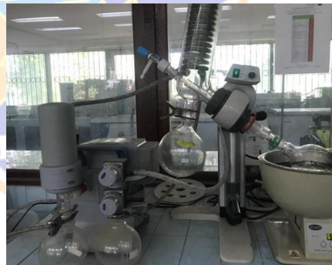
f. Proses Evaporasi Dengan Rotary Evaporator
