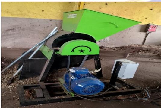
Gambar 25. Mesin pencacah
