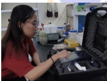
Pengecekan Kualitas Air Menggunakan Photometer
