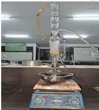
Gambar 4. sokletasi simplisia Daun Bandotan dengan etanol 96%
