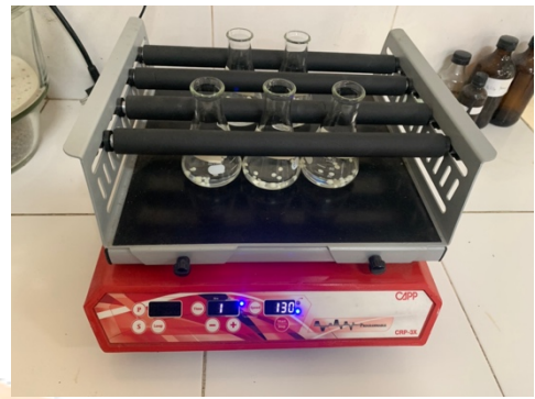
Proses pengadukan dengan pH dan waktu optimum dengan variasi konsentrasi (25,50,75,100,125) mg/L
