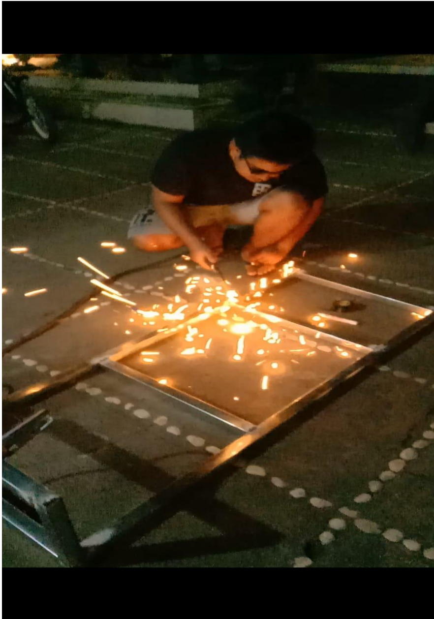
Proses pengelasan rangka
