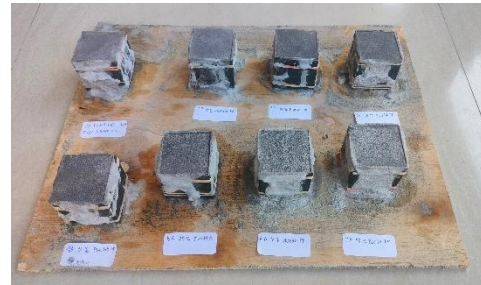
Pendiaman Satu Malam dalam Cetakan
