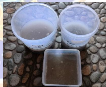
Perendaman Material untuk Uji Berat Jenis & Penyerapan Air
