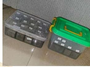
Perendaman dalam Larutan Asam dan Larutan Sulfat
