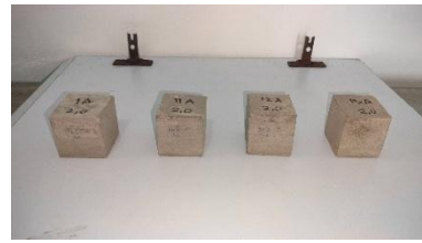
Pendiaman Udara Terbuka & Uji Absorpsi Selama 28 Hari
