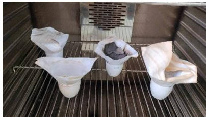
Pengovenan Material untuk Uji Berat Jenis & Penyerapan Air
