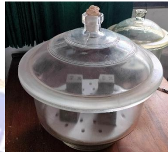
Pendiaman dalam Desikator & Uji Desorpsi Selama 28 Hari
