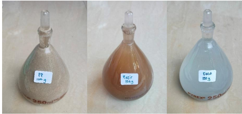
Pengujian Berat Jenis & Penyerapan Air Material
