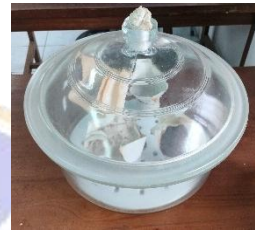
Pendiapan Material untuk Uji Berat Jenis & Penyerapan Air
