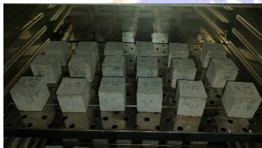
Oven Setelah Perendaman Sulfat dan Asam
