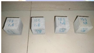
Hari ke-28 Uji Sulfat
