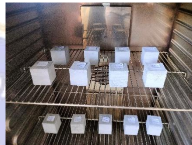
Oven Benda Uji untuk Uji Penentuan Formulasi Optimal
