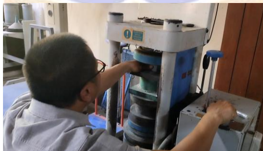
Pengujian Kuat Tekan Serangan Sulfat dan Asam
