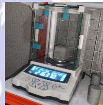
Pengukuran Perubahan Massa Setelah Oven Uji Sulfat dan Asam
