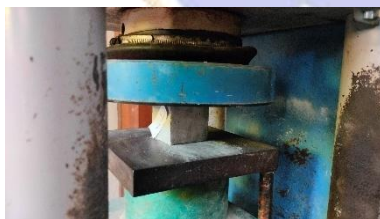
Pengujian Kuat Tekan
