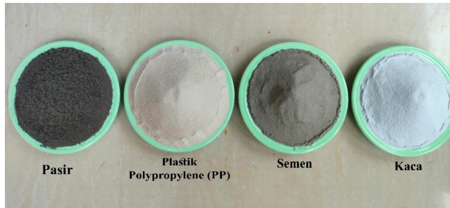
Material Relief Dinding Tiruan (Pasir, Plastik Polypropylene (PP), Semen dan Kaca)
