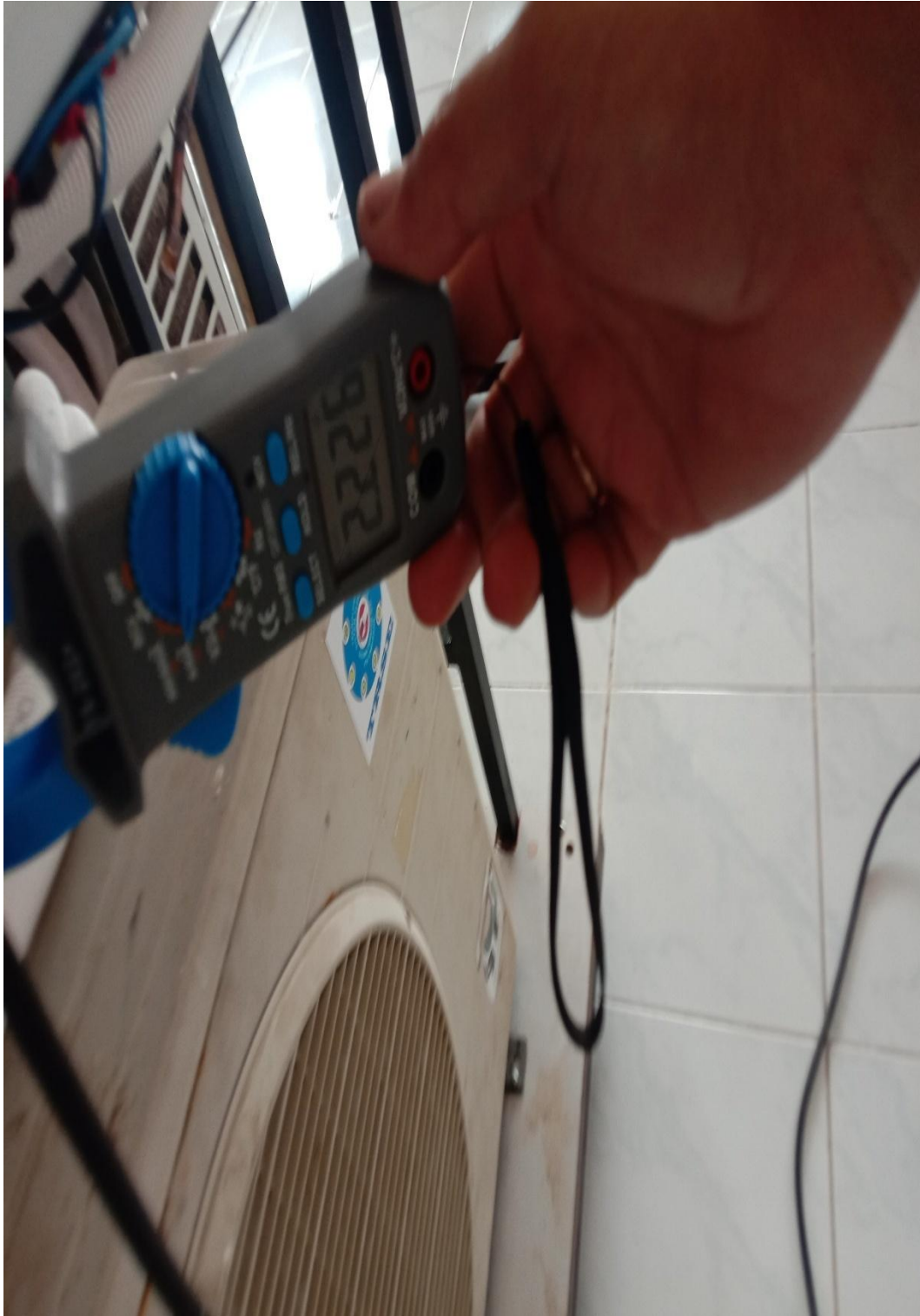
Lampiran 8 Pengukuran Arus Dengan Kondisi Kedua Indoor Aktif Dan Settingan Suhu Remot 16°C
