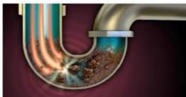
Gambar 2.3 Penyumbatan Wastafel
