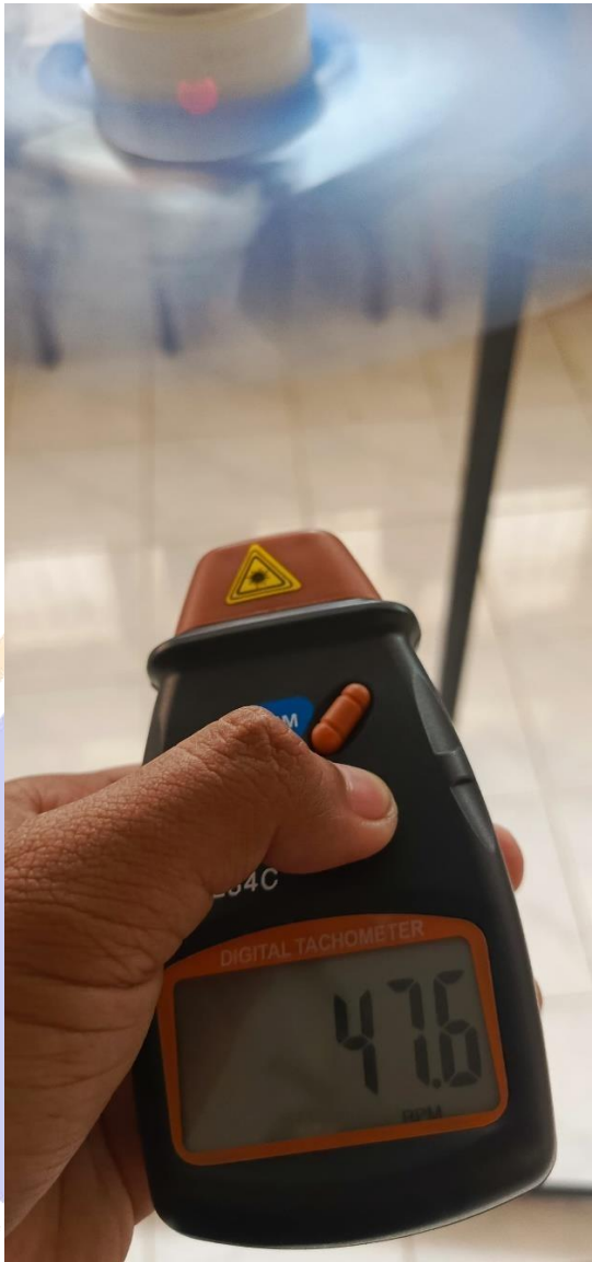
Gambar 7 Pengukuran Rpm Motor Kipas
