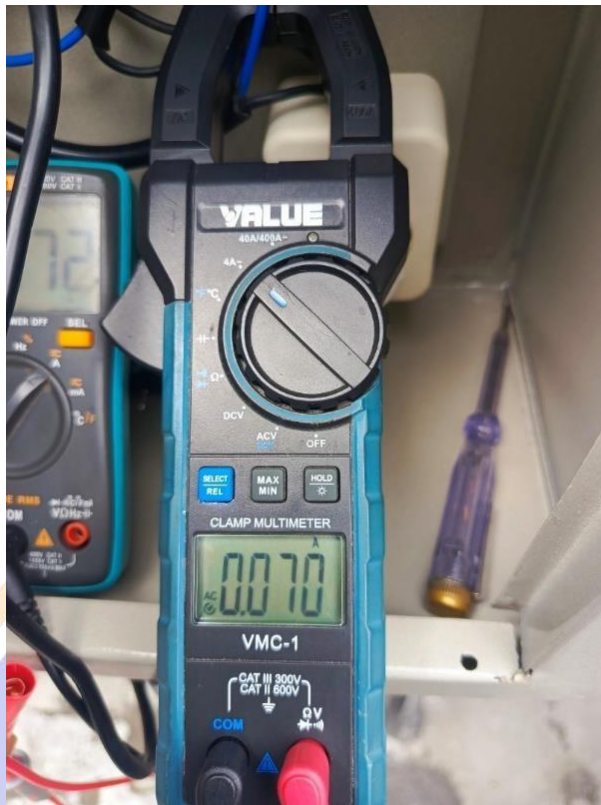
Gambar 6 Pengukuran Tegangan AC Menuju Ke Beban
