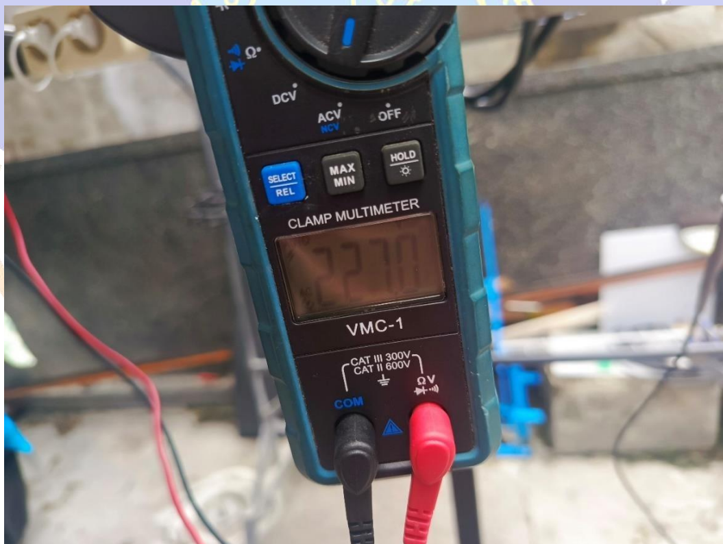
Gambar 6 Pengukuran Tegangan AC Menuju Ke Beban
